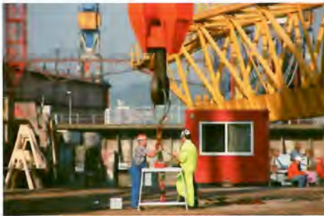
Abb 4: Kranflasche 12 Tonnen Eigengewicht und Auslöseeinheit/Messdose
