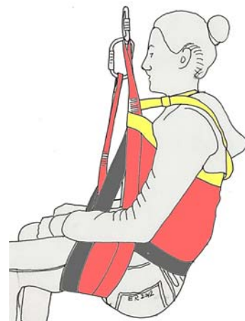
Abb. 6 mit Karabiner im Schrittgurt 10 cm verlängert – Sitzposition etwas aufrechter
