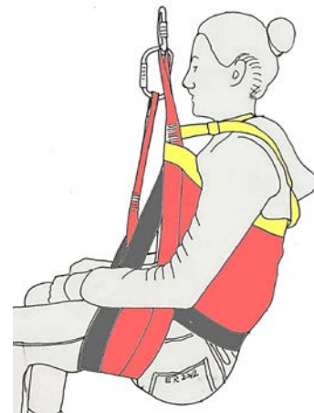
Fig. 6 Un mousqueton sur la sangle entrejambe entraîne un rallongement de 10 cm = position légèrement plus droite
