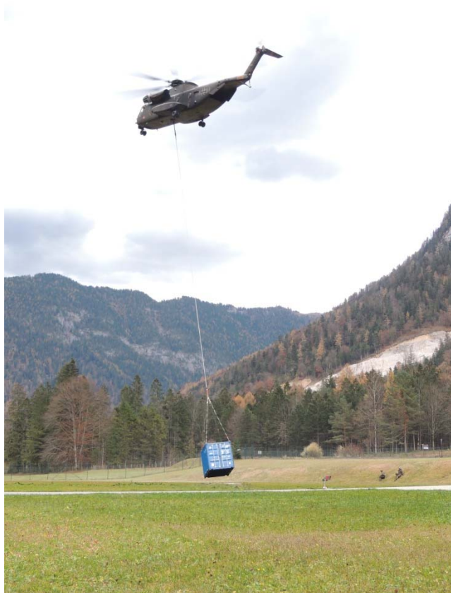
Fig. 1: CH-53 delle forze aeree con fune TLM_90_30 (WLL 90 kN). Per gentile concessione della Airbus MSC.
