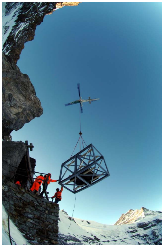
Fig. 4: KAMAN K-1200 "K-MAX" con TLP_55_30 (WLL 30 kN). Per gentile concessione della SBV
