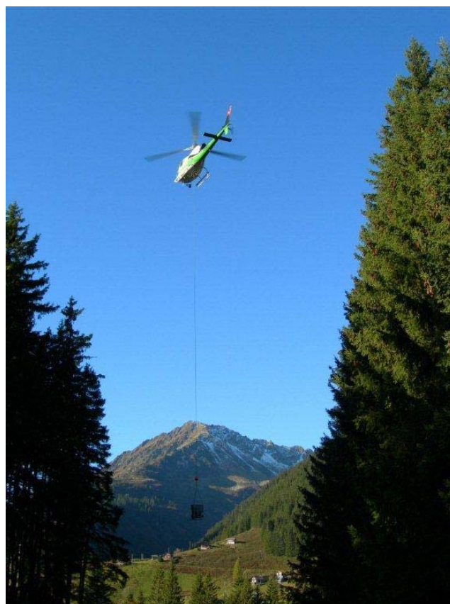
Fig. 2: AS350B3 della Swiss Helicopter AG (Heli Gotthard) con TLDS_14 (WLL 14 kN)
