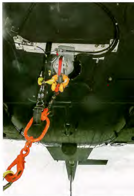
Das Backup Quick Release System von A&H ist Bestandteil des Bergetausystems MERS2 und kommt bei den AS332L1 Super Puma der deutschen Bundespolizei zum Einsatz.
