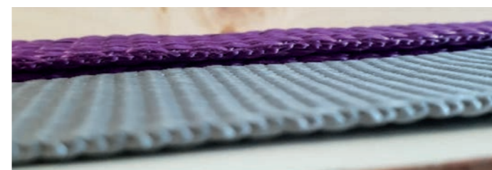
Abb. 4: Ein Hebebänder EN 1492-1 (hinten) und ein Einweg-Hebebänder DIN 60005. Der Unterschied liegt bei 1 zu 3 mm
