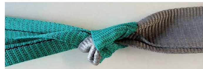
Abb. 5: zusammengeknotete Bänder: der Verlust beträgt > 50%
