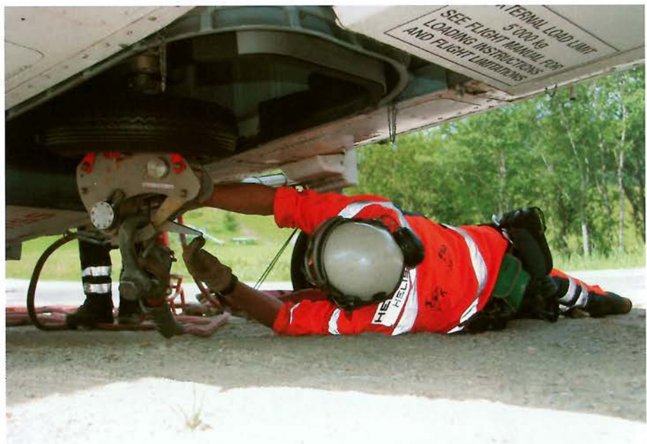
Auch mit der Technik der Hubschrauber, hier der Lasthaken des Kamov Ka-32, müssen die Crews vertraut sein.
