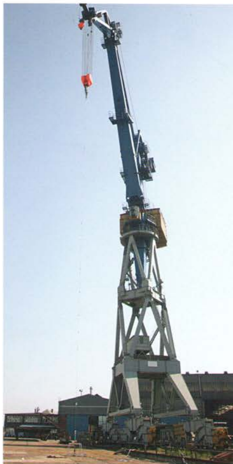
Vertikaler Versuchsaufbau zur Beurteilung des Hochschlagverhaltens auf dem Gelände der Blohm + Voss Werft in Hamburg. Damit wurden Lastenseile bis zu einer Länge von 40 m getestet.
