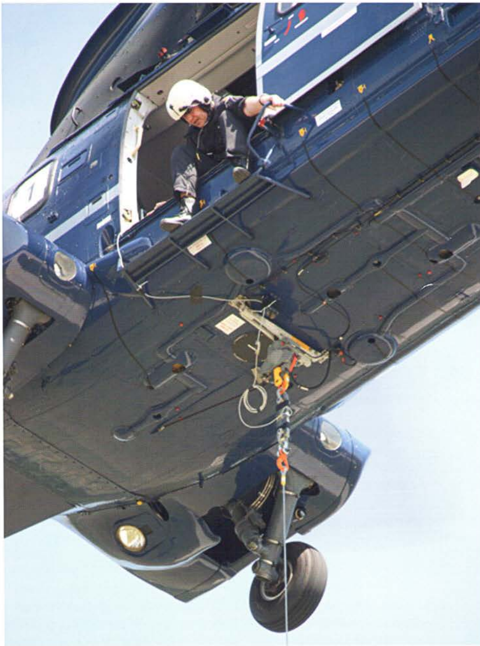
Ein Hubschrauber des Typs Eurocopter AS 332 Super Puma während der Aufnahme von Messdaten. Der Zeitaufwand für das Erliegen einer Messreihe betrug bis zu 3 Tagen.
