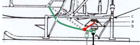
Abb. 4 Schematische Darstellung einer Redundanz (grün) mit Rückhaltevorrichtung (rot)
