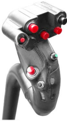
Abb. 2 Stick (elektrische Auslösung); Abb. 3 Pitch (mechanischer Hebel liegt unter der Hand des Piloten)
