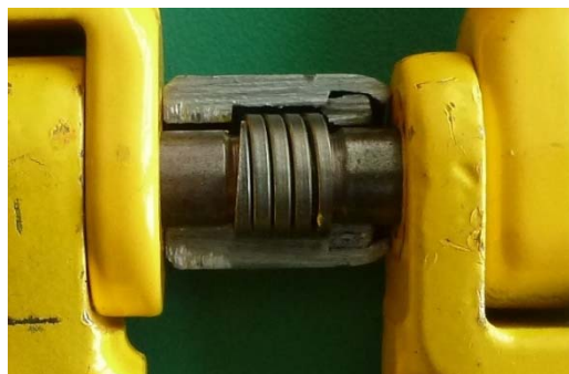
Abb. 14 Position der Hülse mit Feder zwischen den Hebeln der Verbindungsglieder.
