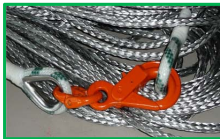
Fissaggio della corda abbiaciata con una delle sue estremità
