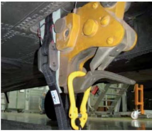
Abb. 9: Lasthakensystem CH-53 (mit Funktionsmuster einer Redundanz)
